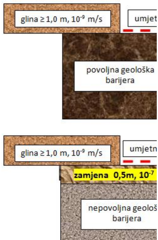
Slika 5. Postupak rješavanja nepovoljne geološke barijere u temeljnom tlu ispod odlagališta otpada sa izvedbom temeljnog brtvenog sloja u prirodnom i umjetnom materijalu (11)
