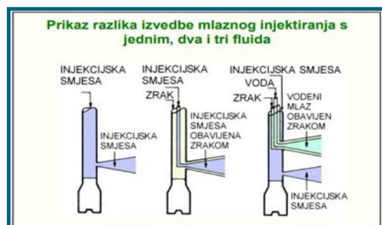
Tipovi tehnologije mlaznog injektiranja
