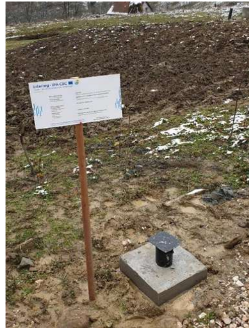
Slika 4. Instaliran pijezometar u bušotinu
